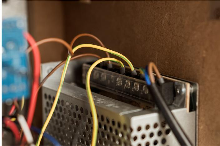
**Abbildung 4.23:** Verkabelung des Netzteils
