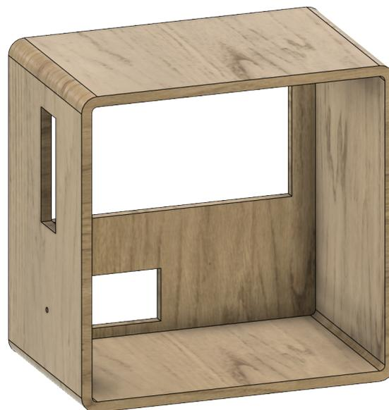
**Abbildung 4.7:** Rückansicht des ATM-Gehäuses mit Zugang für Wartungsarbeiten
