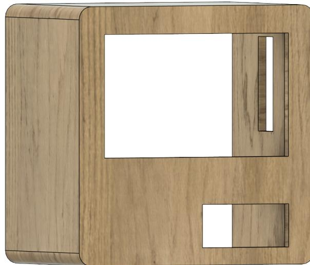
**Abbildung 4.6:** Vorderansicht des ATM-Gehäuses mit vorbereiteten Öffnungen für Display und Münzeinwurf
