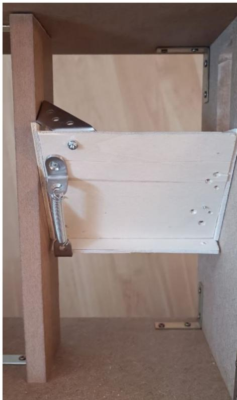
**Abbildung 4.19:** Auffanggehäuse mit Widerstandsfeder
